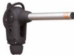
Gelenke mit Seilantrieb ... drehen und schwen- kend Wired driven joints ... rotating and pivoting
